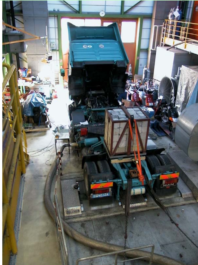
Rollenprüfstand für Schwere Nutzfahrzeuge der TU-Graz
